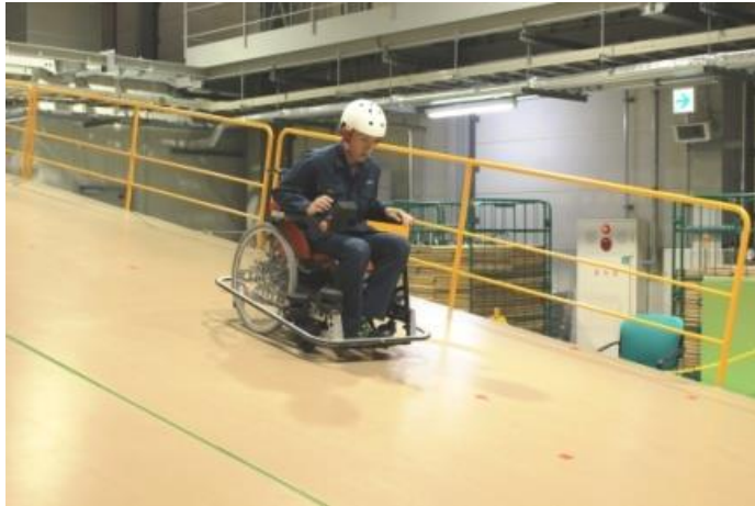
最高速試験・制動試験
