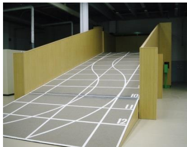
傾斜安定性試験路
