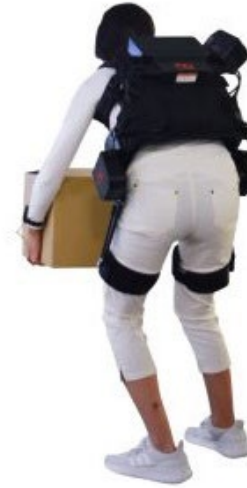
モーター式パワーアシスト スーツ
