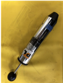
図 JIS 60068-2-75 スプリングハンマー試験器
