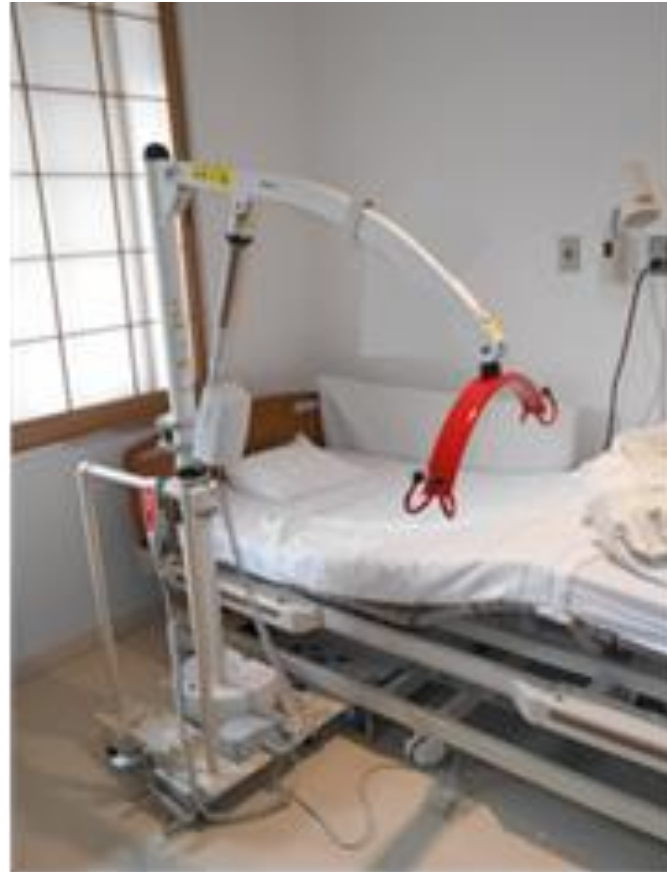
リフト部をベッドに固定した状態
