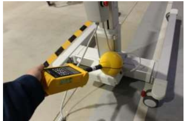
図 4-4-2 測定状況の例 電界測定
