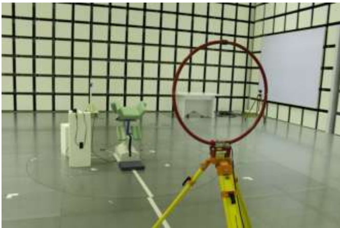
図 4-5-2 測定状況の例 測定距離 3m
