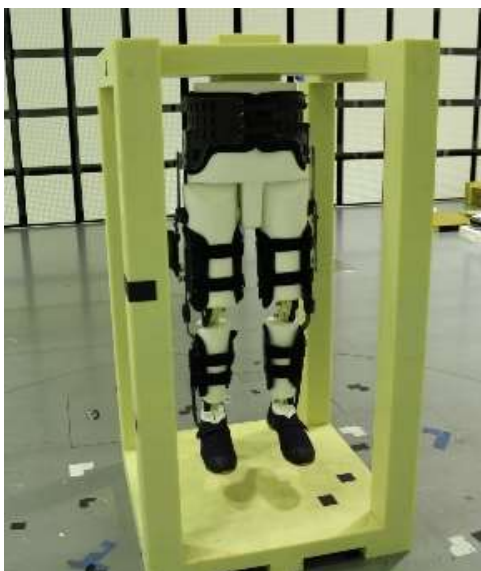
図 4-25-3 開発した試験装置へ供試品を模擬したモックアップを装着した状態
