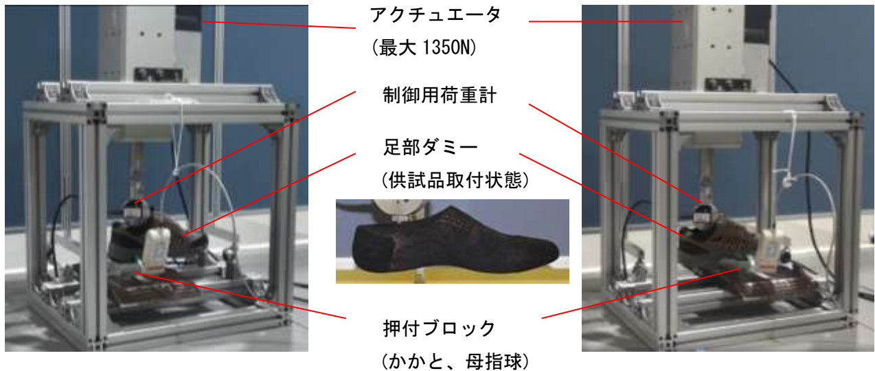
図 4-24-2 センサ断続荷重試験装置
