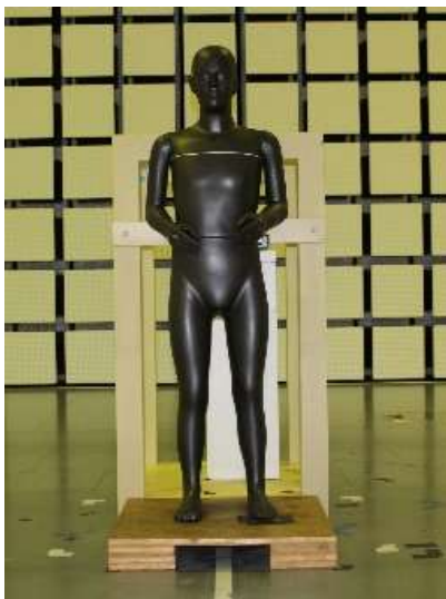
図 4-25-1 人体の誘電率を模擬したラバーファントム
