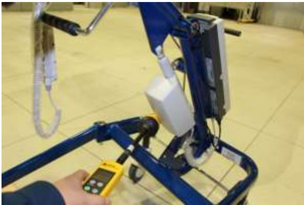
図 4-4-1 測定状況の例 磁界測定
