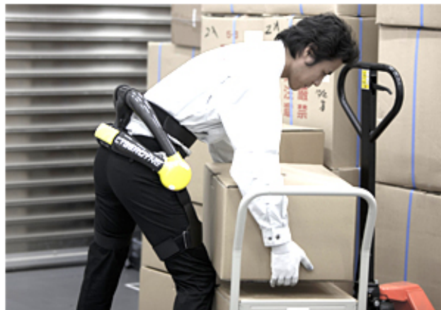
作業・介護支援用装着型ロボットとして世界初のISO 13482認証を同時取得した2製品： 左：HAL作業支援用(腰タイプ)、右：HAL介護支援用(腰タイプ)
