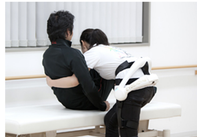
作業・介護支援用装着型ロボットとして世界初のISO 13482認証を同時取得した2製品： 左：HAL作業支援用(腰タイプ)、右：HAL介護支援用(腰タイプ)
