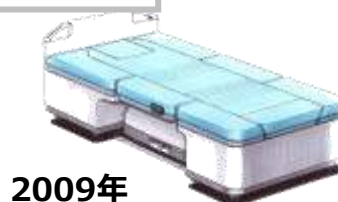
ベッド→車いす変形ロボット（離床アシストロボット） 「ロボティックベッド」、「リショーネ」
