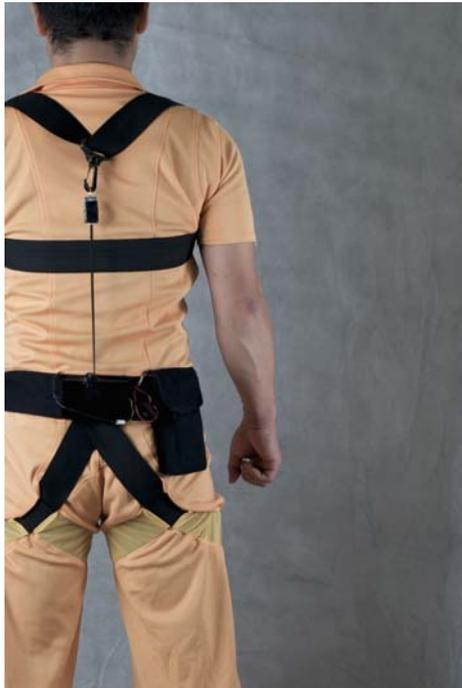
柔らかく軽いストレッチ素材などの弾性体が発生する力を作業姿勢や動作から最適なアシスト・パワーに変換するセミアクティブ・アシスト・システムを実装した装着型の筋力補助装置です。使用者の身体に無理な力を加えず、動作を妨げたり制限しないため幅広い用途での応用が期待されています。
