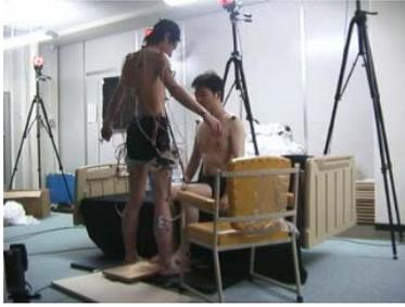
MAC3Dシステム(カメラ15台)によるベッドからの移乗介助計測
