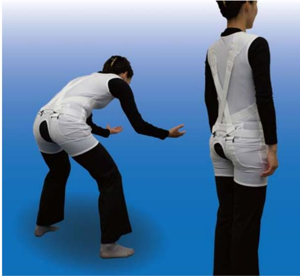
弾性材を補助力源として、同時に筋力補助と体幹安定化補助を実現
