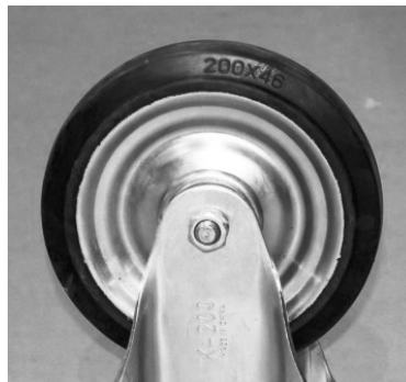
図 4-2 想定したロボット介護機器のソリッドタイヤ （直径 200 mm、総幅 45 mm、トレッド幅 30 mm、ゴム硬度 A80）
