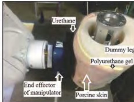
図 6-6 ダミー摩擦実験装置
