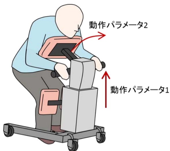
図 2-6 2 自由度の立ち上がり動作支援機器の例
